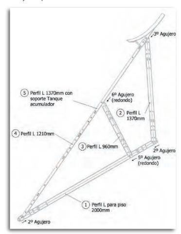
3) Una vez armados los dos laterales del soporte panel, unir los mismos mediante los Ítems 7 como se muestra en la figura:
