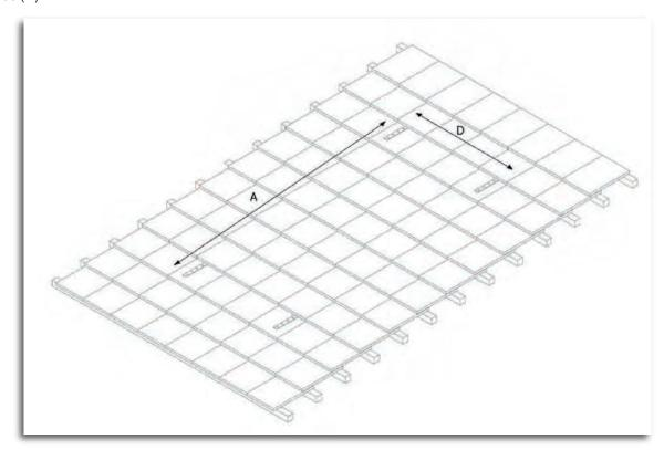
3) Colocar sobre la base armada con los Ítems 1 y 3, el soporte panel compuesto por los Ítems 4, 5 y 6.
